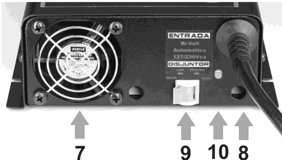
**7 – Saída de Ar.** Saída de ar para a ventilação e resfriamento da fonte, não obstruir de forma alguma, sempre deixar um espaço de no mínimo 5cm para uma perfeita ventilação do equipamento.
